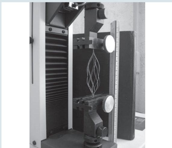
Рис. 7. Фото кава-фільтра в розривній машині HOUNSFIELD
